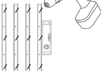
2. Определите расстояние между рейками (по стандарту расстояние между рейками равняется ширине выбранной модели рейки). В этом случае для Миланы и Ривьеры расстояние между монтажными планками - 47мм., для Брионы - 67 мм.
