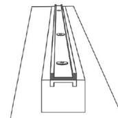
7. Вставьте сдвоенные рейки для наполнения на выбранном расстоянии (стандартно - это ширина сдвоенной рейки).
