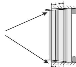
9. Для дополнительной прочности перегородки и визуальной эстетики нарежте рейку Ривьера на кусочки, равные расстоянию между сдвоенными рейками. Вставьте кусочки между рейками и полозьями на полу и потолке.
