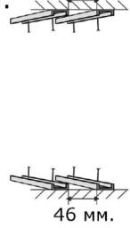
5. Возьмите вторую рейку и защелкните на монтажную планку. Повторите пункт 4.1 и 4.2 до тех пор, пока не получите нужное количество реек для наполнения перегородки (по стандарту расстояние между рейками равняется ширине выбранной модели рейки).
