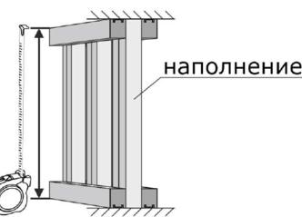
2. Определите высоту перегородки, определитесь с наполнением перегородки (Бриона, Милана, Ривьера) отрежте рейки и монтажные планки нужной длины.
