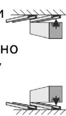
8. Защелкните рейки на полу и потолке (для монтажа на потолке дополнительно используйте клей).
