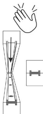
6. Для основания перегородки защелкните одну рейку на потолке и одну противоположно на полу на монтажную планку (пункт 3). Для монтажа на потолке дополнительно используйте клей.
