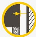
В углах необходимо оставить зазор 5-10 мм для предотвращения передачи ударного шума.
